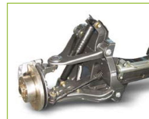
Механическая передняя подвеска с поперечной рессорой
