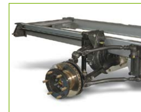
Механическая торсионная передняя подвеска
