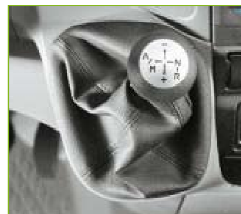
Селектор коробки передач AGile™ на приборной панели
