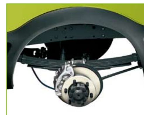
Задняя подвеска на полуэллиптических рессорах
